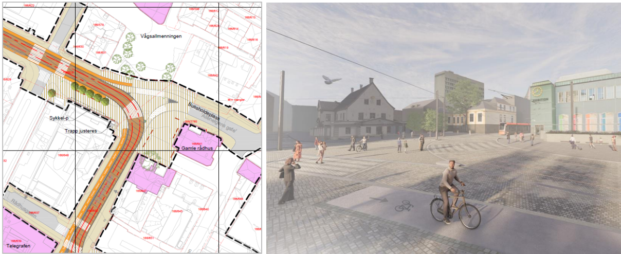
Figur 15 og 21- Utsnitt av illustrasjonsplan og illustrasjon som viser bybanetrasé og sykkelløsninger i krysset Christies gate – Småstrandgaten/Allehelgens gate
