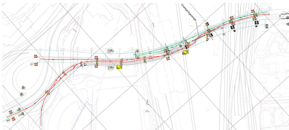
Figur 9 Tovegsregulering på Nygårdstangen med nordlig tunneløp stengt.
