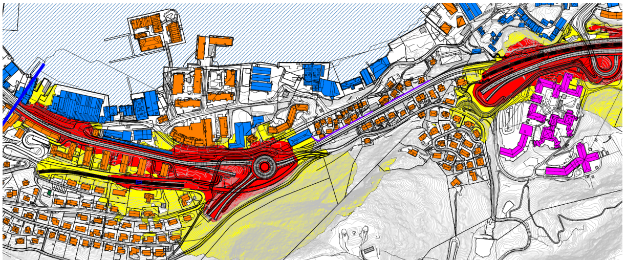
Figur 66: Summert støynivå (gul støysone, L_{den} > 55 dB og rød støysone, L_{den} > 65 dB) fra veg og bane i utbygget situasjon beregnet 4 m.o.t. Kartet viser området fra Amalie Skrams vei i sør til Sandviken sykehus i nord. Nord er mot høyre i figuren.
