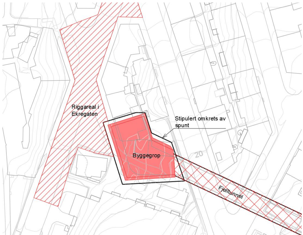
Figur 73: Arbeid med byggegrop og tunneldriving til nordlig inngang
