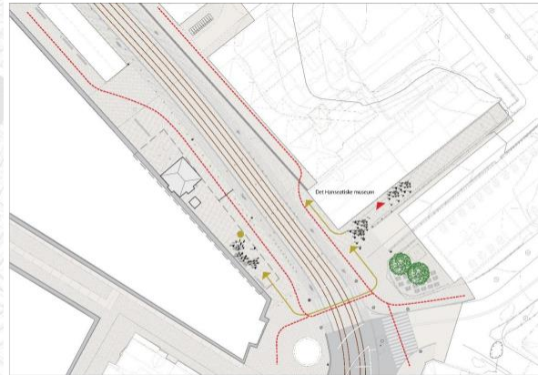
Figur 2.2 Figuren viser bevegelsesmønster og oppholdsareal rundt Det Hanseatiske Museum. Aikanten vil fremdeles være tilgjengelig for båter. (Ill. Bymiljøetaten)
