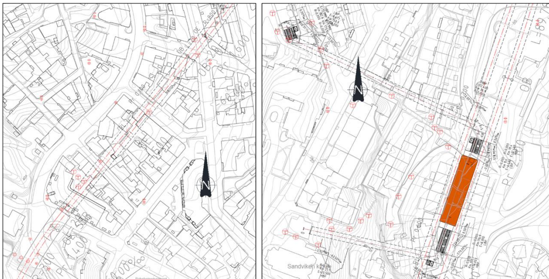
Figur 2-5: Oversikt over grunnboringer (vist i rødt) som ikke kunne utføres grunnet konflikt med teknisk infrastruktur i bakken. Til venstre: Skuteviken. Til høyre: Sandvikskirken holdeplass.
