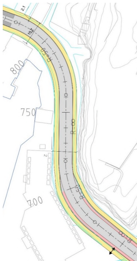
Figur 3: Til venstre: Opprinnelig forslag til plan forbi Sverresborg, der det var lagt til grunn sykkelfelt med overgang til sykling i blandet trafikk.
