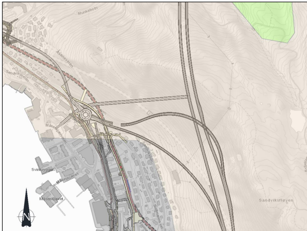
Figur 2-1: Utsnitt fra NGUs løsmassekart (1:50 000) på nett lagt over gjeldende veg- og banemodeller. Brun farge indikerer bart fjell. Mørk grå farge indikerer fyllmasser. Det må forventes noe fyllmasser i tettbygd strøk også innenfor det brune området. Lys grønn farge indikerer tynt morenedekke.
