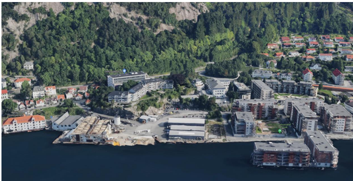
Figur 5-7 Saltimporttomten har tilstrekkelig areal til en tunnelrigg, samt gir mulighet til at tunnelmassene kan fraktes bort sjøveien. Skjermdump fra jordklodevisningen til Google maps.
