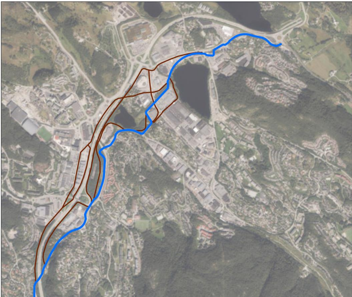
Figur 2-2: Oversikt vurderte alternativer i skissefase for hovedrute for sykkel. Blå strek viser valgt trasé for hovedsykkelrute.
