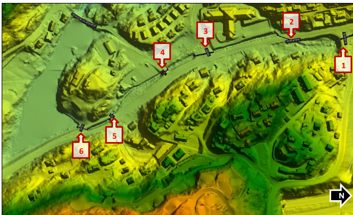
Figur 1. Terrengmodell av dagens situasjon for bekken langs Ervikveien. Veikryssinger/strukturer/konstruksjoner er nummerert i figuren.
