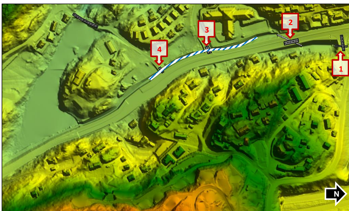
Figur 15. Nytt tiltak - Planlagt terrengutforming og strukturer. Blå skråningen viser område hvor bredden til bekkeløpet bør økes fra 1,8 til 3,5 m.
