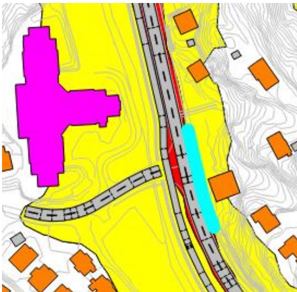
Figur 53: Samlet støynivå (gul støysone, L_{den} > 55 dB og rød støysone, L_{den} > 65 dB) fra veg og bane i utbygget situasjon ved Ervikveien 115. Ny foreslåtte støyskjerm er vist i turkis. Beregningshøyde 4 m.o.t.
