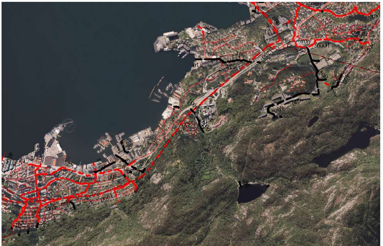
Figur 5: Oversikt hovedsystemer for felles avløp og overvannsledninger
