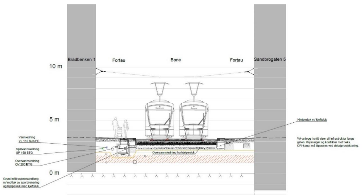
Figur 7.3-3 Sandbrogaten 5, Tegning F-10010, tverrsnitt O-O', område der kulturlag antas å ligge grunnest
