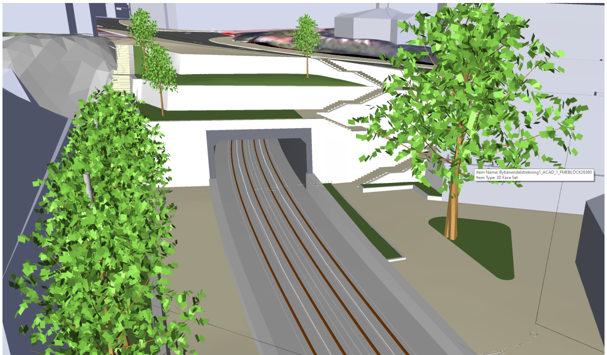
Figur 4.4-2 Konstruksjon K104 Baneportal Sandbrogaten.
