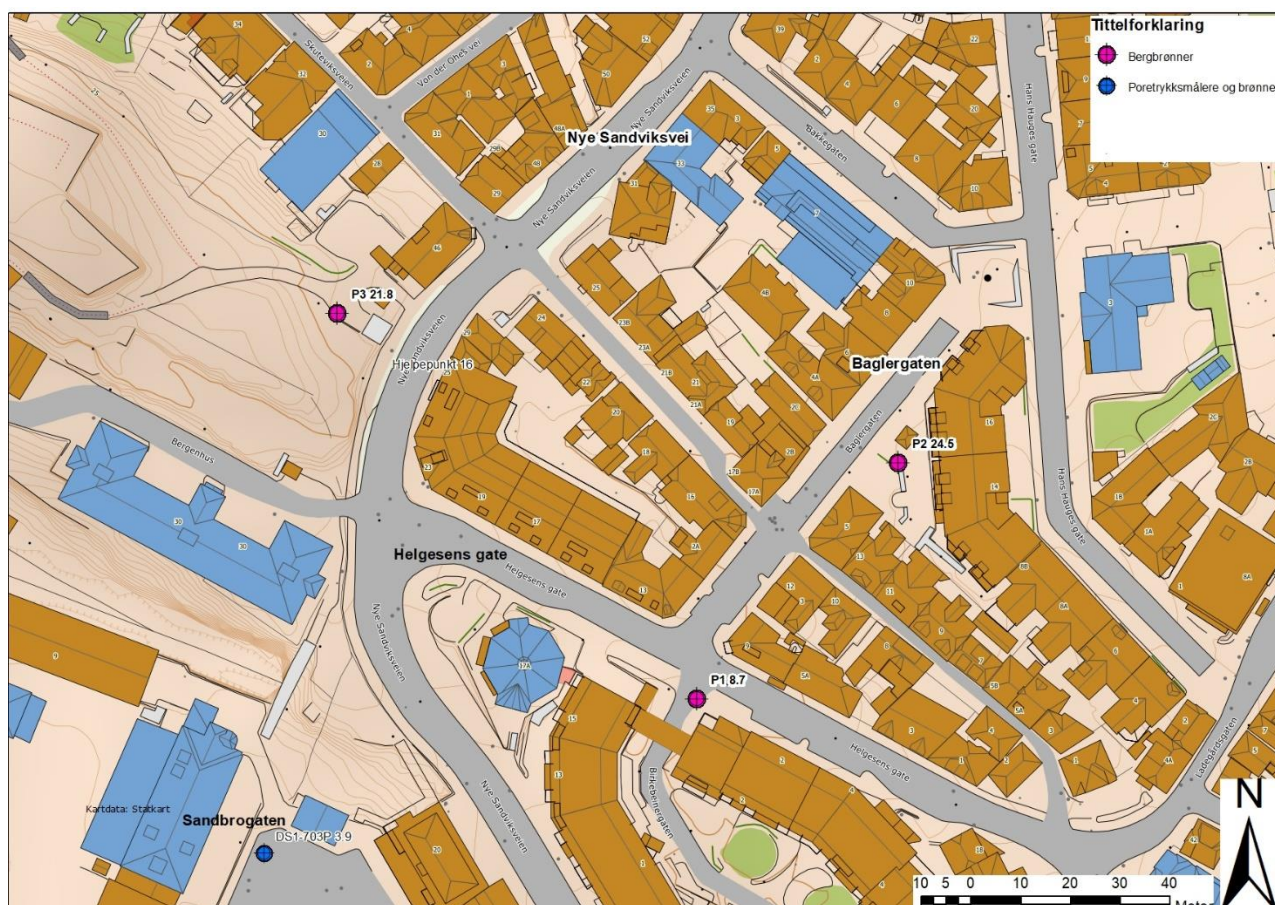
Figur 2-1: Bergbrønner med grunnvannstand (målt i desember 2021) og målt poretrykk i Sandbrogaten (mars 2021).
