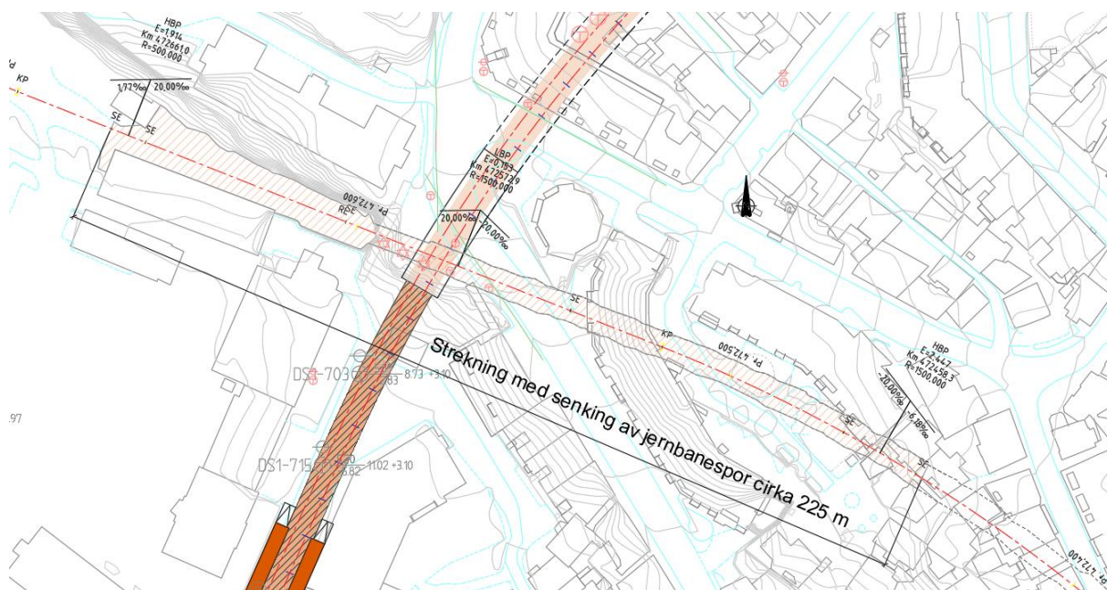
Figur 3-6: Illustrasjon som viser på hvilken strekning jernbanespor må senkes for å komme under et redusert Bybanetunnelprofil.
